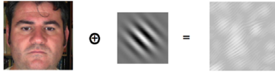
Şekil 3. Örnek bir görüntünün 45° açıda ve 4 ölçeğindeki bir Gabor filtresi ile konvolüsyonu.
